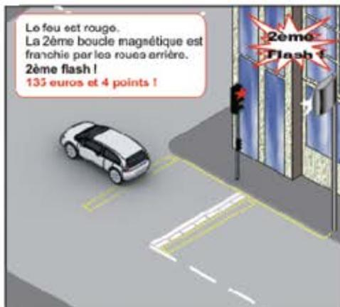
Alors que le feu est rouge, si les roues arrière du véhicule franchissent la 2<sup>ème</sup> boucle magnétique, un deuxième flash se déclenche.
