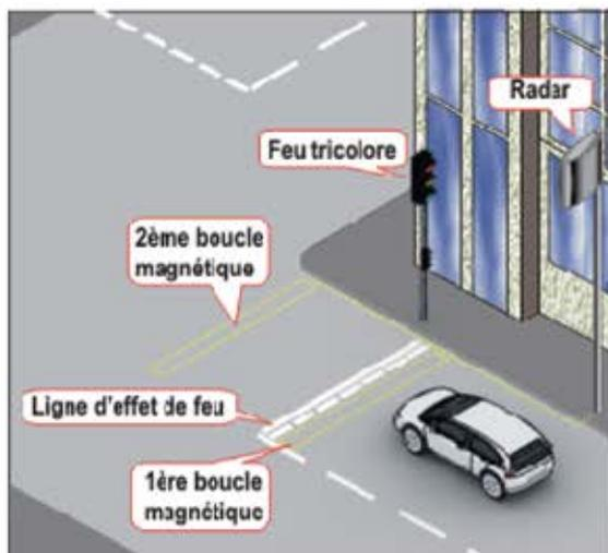
**Le radar :** placé à environ 20 mètres avant le feu. Il se fond dans le décor et n'est pas facilement identifiable.
